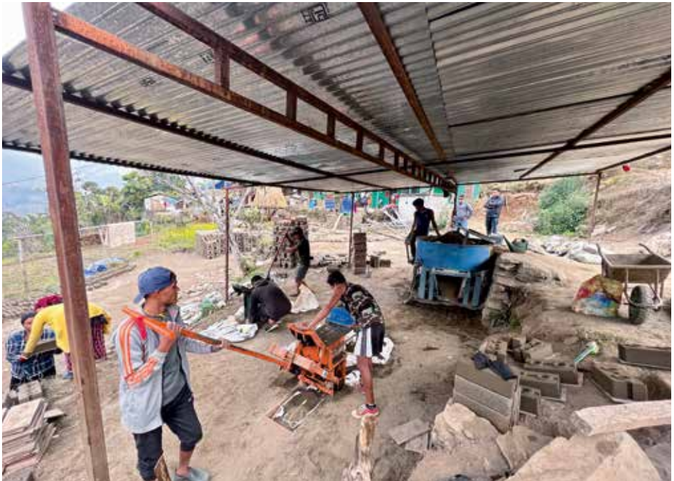
In dieser Manufaktur werden die Erd-Bausteine gepresst.
