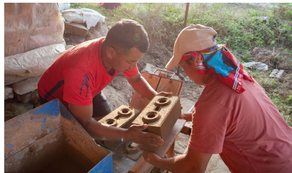
Handarbeit: Herstellung der Interlocking Bricks.
